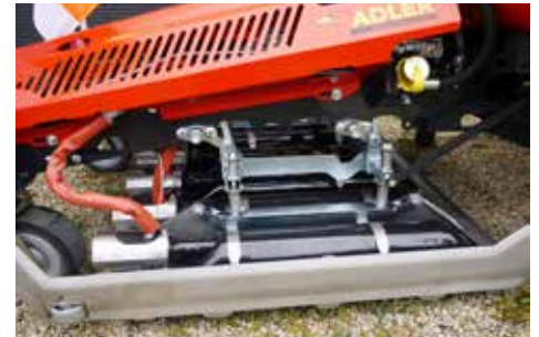
Federnd gelagerte und per Funkfernbedienung höhenverstellbare Infrabox
