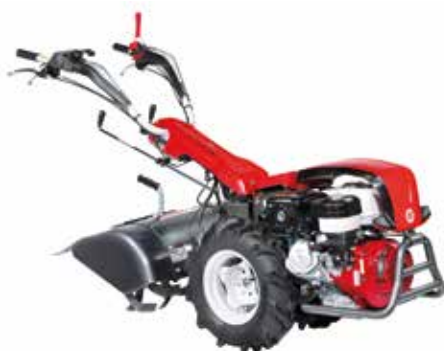
413S-270 mit Bereifung 4.00-10 und 60 cm Anbaufräse (optional)
