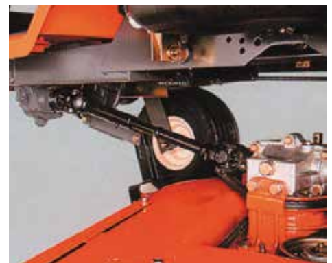
Messerantrieb über Kardanwelle bei allen Modellen.
