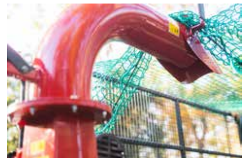
Schwenkbarer Auswurfkanal und verstellbare Auswurfklappe
