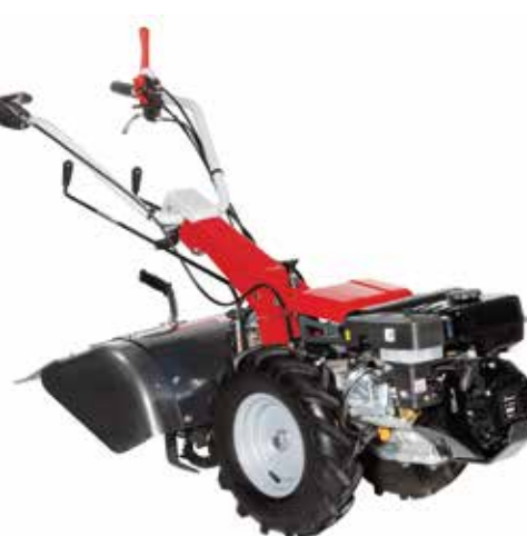
405S-200 mit Bereifung 4.00-8 + Fräse 60 cm (optional)
