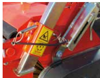
Abstellstütze und stufenlos höhenverstellbare Kehrwalze
