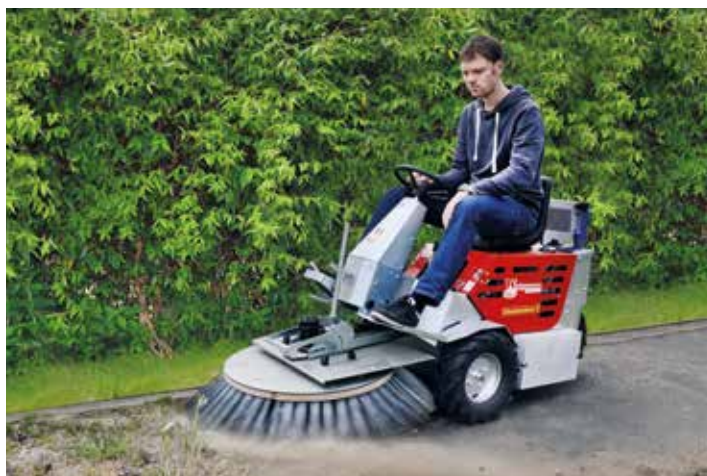
Radialbesen mit Drahtbesatz
