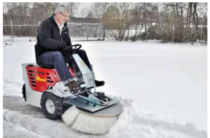
Die Arbeitsbreite des R 1000 beträgt 100 cm, die Bürste lässt sich sowohl links- als auch rechtsrum drehen. Ideal geeignet zum Schmutz- u. Schneekehren.
