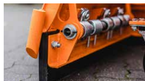
Federklappenelemente mit Gummileiste
