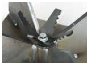
Piranha-Messer zur Volumenreduzierung
