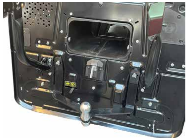
Anhängervorrichtung Gartenland / Stiga / Honda 102 / 122 cm (großer Rahmen) mit Kugelkopf für kleine PKW-Anhänger
