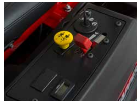
Intuitives Bedienpanel inkl Stundenzähler direkt neben dem Sitz
