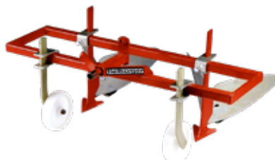
Häufelkörper 2-reihig mit großen Rahmen und Stützrädern
