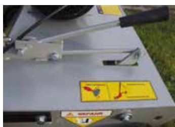
Stabiler Absenkmechanismus mit Feinjustierung
