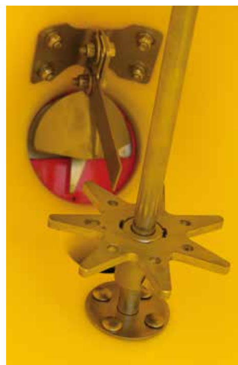
zusätzliches Rührwerk gegen Brückenbildung
