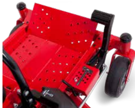
Einfache Mähwerksaushebung per Fußpedal mit geringem Kraftaufwand
