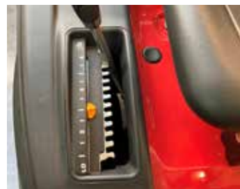
Einfache Höheneinstellung des Mähdecks
