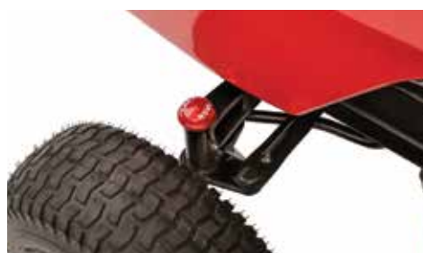
Robuste, schwenkbare Vorderachse aus Gusseisen mit Schmiernippeln.
