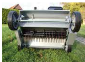
Am Fliehkraftsystem aufgehängte, gehärtete 3mm Vertikutiermesser
