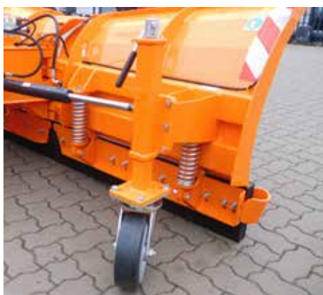
Federklappen als Überfahrtschutz, 50 mm Gummifleiste, Anfahrtschutz und höhenverstellbare Stützräder
