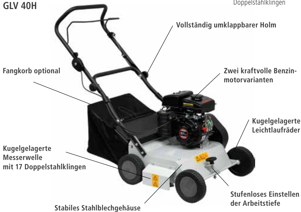
Kugelgelagerte Vertikutierwelle mit gehärteten Doppelstahlklingen
