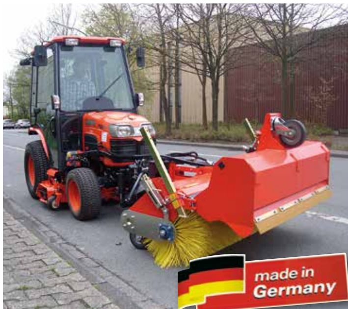
Abstellstütze und stufenlos höhenverstellbare Kehrwalze
