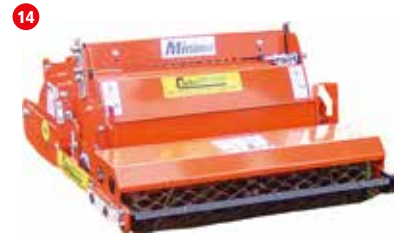
14 Umkehrfräse 64 cm mit Motorfrontgewichten, Gitterwalze
