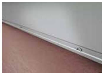
Zurringe in den Seitenwänden integriert
