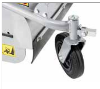
Räder 360 Grad drehbar oder zu arretieren
